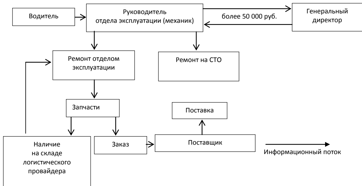
Рис. 2. Предлагаемый алгоритм процесса управления ремонтом ТС
